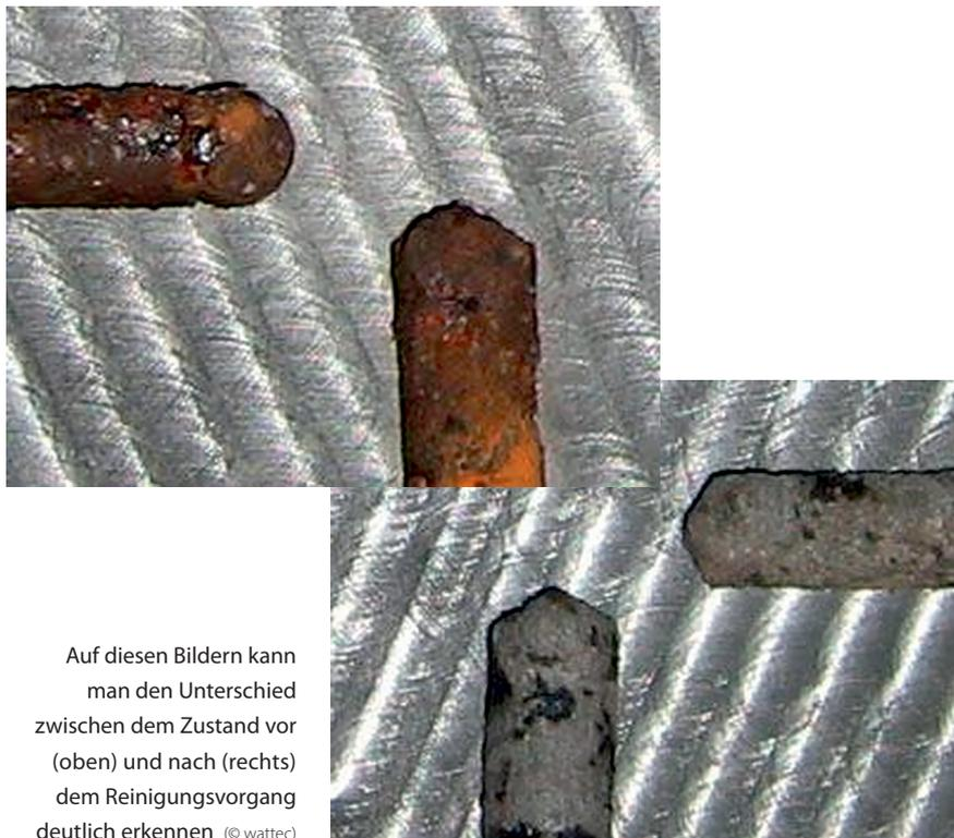
Auf diesen Bildern kann man den Unterschied zwischen dem Zustand vor (oben) und nach (rechts) dem Reinigungsvorgang deutlich erkennen (© watec)
