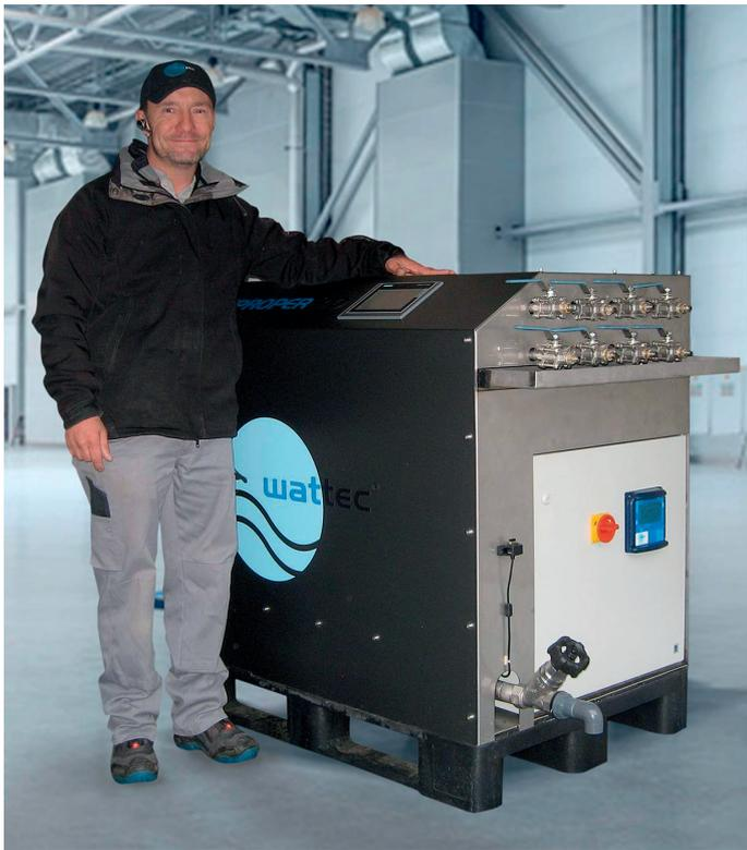
Der Dreyproper verfügt über die praktische Europalettengröße, sodass das mobile Gerät flexibel auch in Betriebshallen mit wenig Platz eingesetzt werden kann (© watec)
